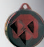
брелок для загрузки кодов в электросчетчик
